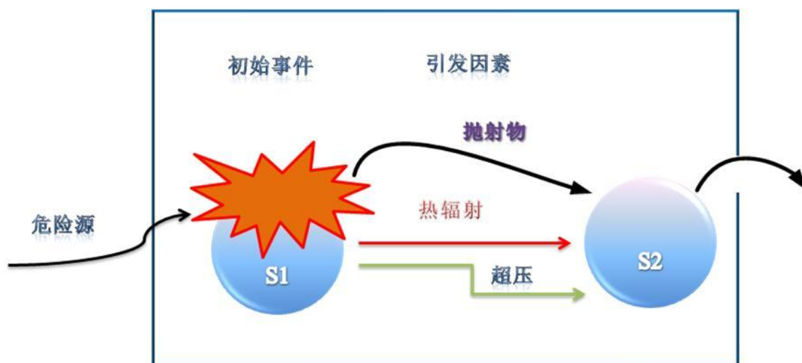
图3.6.5-1多米诺效应系统图
