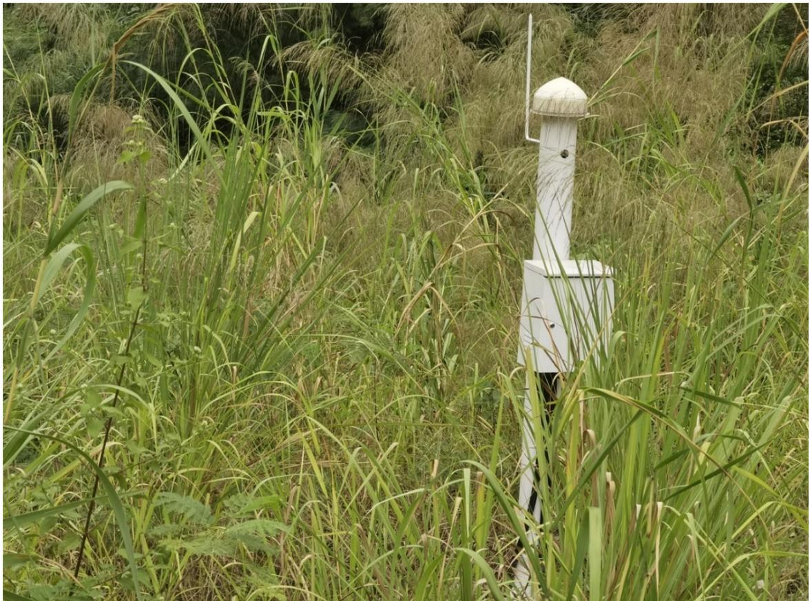
图 2-11 位移在线监测装置
