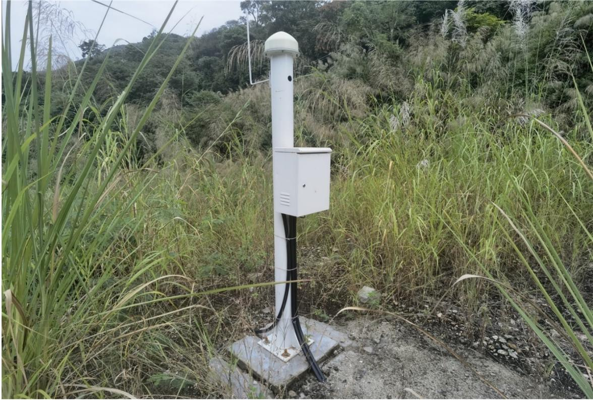
图 2-10 位移在线监测装置
