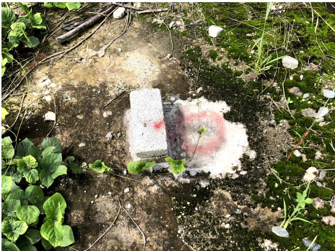
图 2-12 位移人工监测点
