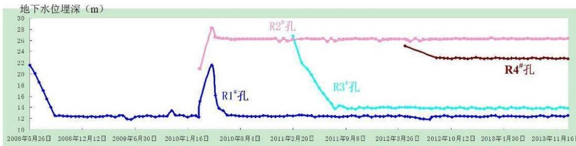
图 2-7 钻孔 R1#~R4#孔动态监测（地下水位埋深）
