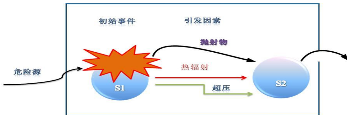
图 6.3-1 多米诺效应系统图
